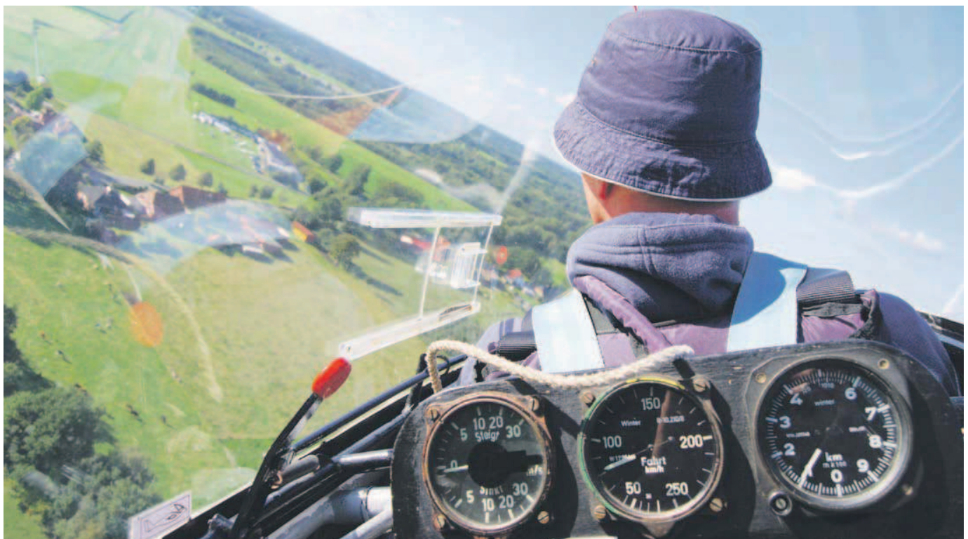
Heiko Seibt im Landeanflug: Die Apparaturen zeigen Steigen bzw. Sinken, Geschwindigkeit und Höhe an.
