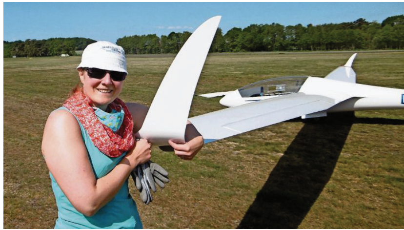
Kleine Ursache große Wirkung: Ilona Kemme zeigt eines der beiden neuen Winglets an der LS 4. Was wie eine kleine Haifischflosse aussieht, verhindert eine Wirbelbildung mit schädlichem Luftwiderstand am Flügelende. Dadurch verbessern sich die Gleitflugleistungen bei Segelflugzeugen. Die Umrüstung konnten die Tarmstedter Segelflieger in ihrer Werkstatt selbst vornehmen. FOTO: PRIVAT
