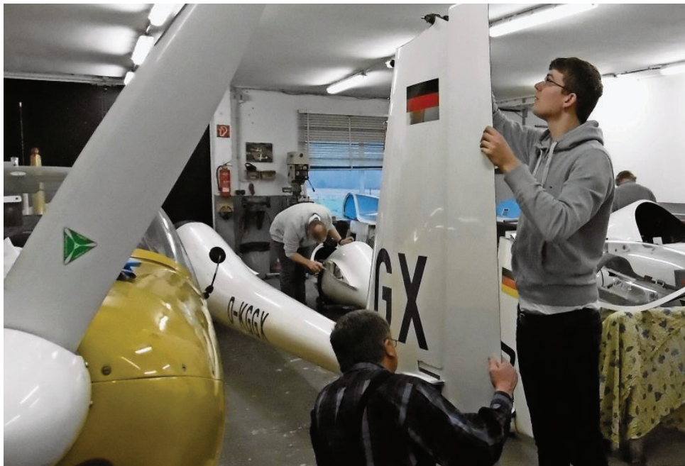
Sebastian Simon und Martin Zimmermann (knieend) setzen das Seitenruder des Doppelsitzers Duo-Discus wieder ein, das für die Wartungsarbeiten herausgenommen worden war. Foto: Hubert
